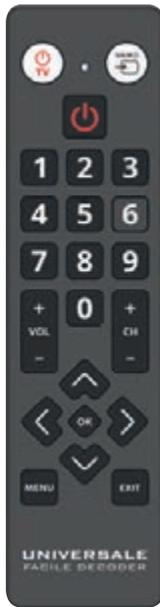
Telecomando semplificato universale per tutti i decoder programmabile tramite inserimento del codice o con la funzione learning TV. Per controllare contemporaneamente TV e decoder. I tasti grandi ne facilitano l'utilizzo. PILE:2x1,5V AAA (Art. 30/30000-00) (Non include).
