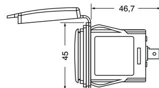
Doppia presa di alimentazione ad alta potenza adatta a tutti i mezzi dotati di alimentazione 12/24V tipo moto, auto, barche, camper. Con tappo siliconico; presa resistente all'acqua. Con LED luminoso di funzionamento. INGRESSO: 12/24VCC DIMENSIONI: 46.7x45x20mm DIMENSIONI FORO PANNELLO: 21x37mm
