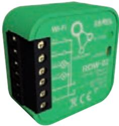
Modulo Wi-Fi per il controllo di prese e illuminazione a 2 Canali e 2 Ingressi, di piccole dimensioni e design moderno. Gestione tramite protocollo Supla, grazie al quale si entra nel mondo del IoT (Internet delle Cose)
